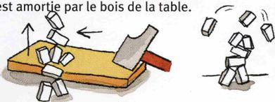
L'onde provoque des chocs à l'horizontale qui disloquent les murs, et à la verticale qui les font sauter.
